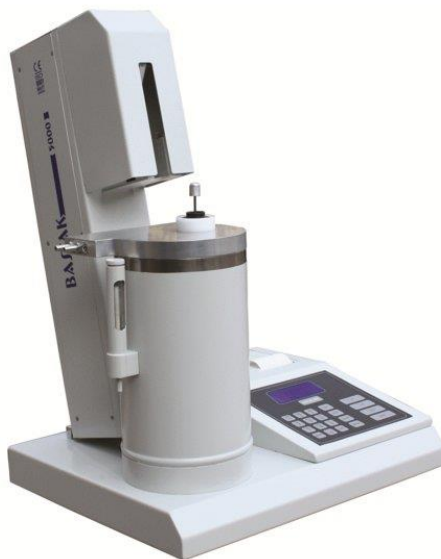
Slika 6. Uređaj za određivanje broja padanja (Anonymus_7, 25.10.2015., url)
