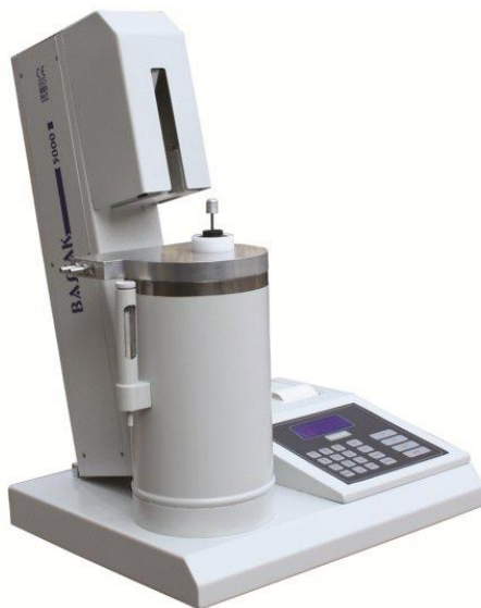
Slika 6. Uređaj za određivanje broja padanja (Anonymus_7, 25.10.2015., url)
