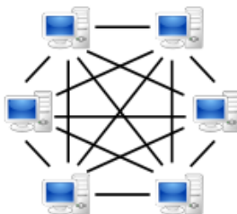
Slika 39. Mreža ravnopravnih računala Izvor: tinyurl.com/y7qs7sm9 , pristup ostvaren: 09.04.2017.
