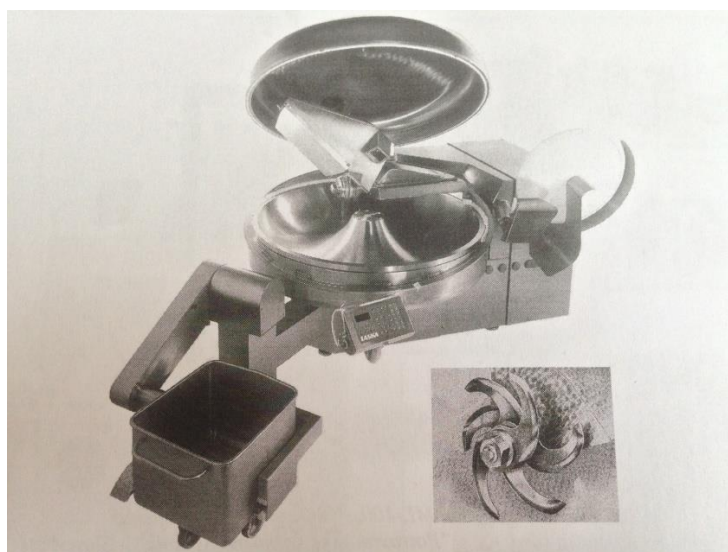
Slika 1. Kuter i noževi kutera, „Laska“- Austria (Kovačević, 2001)
