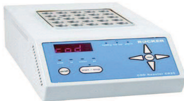
Slika 9. COD reaktor za određivanje KPK (Anonymous_5, URL)
