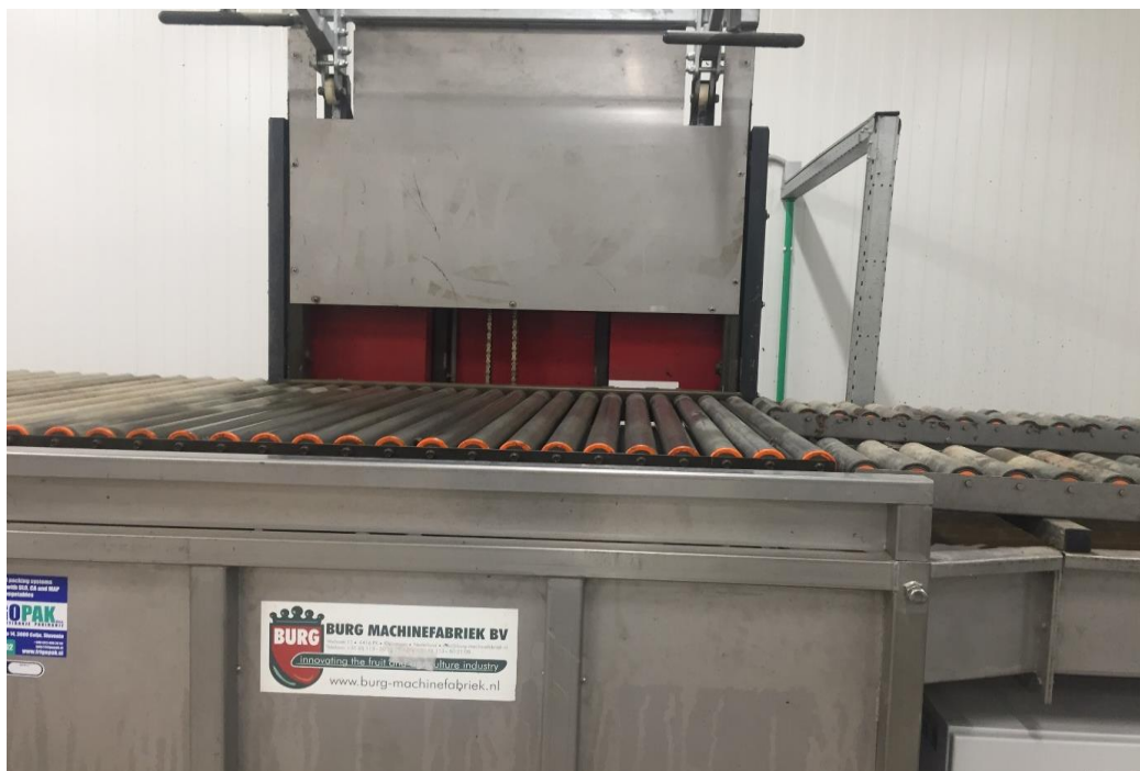
Slika 2. Valjci za prijenos jabuka za daljnje radnje (Izvor: Autor)
