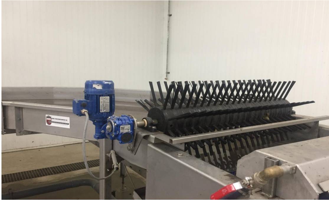
Slika 3. Dio uređaja za sortiranje namijenjen za pretpranje (Izvor: Autor)
