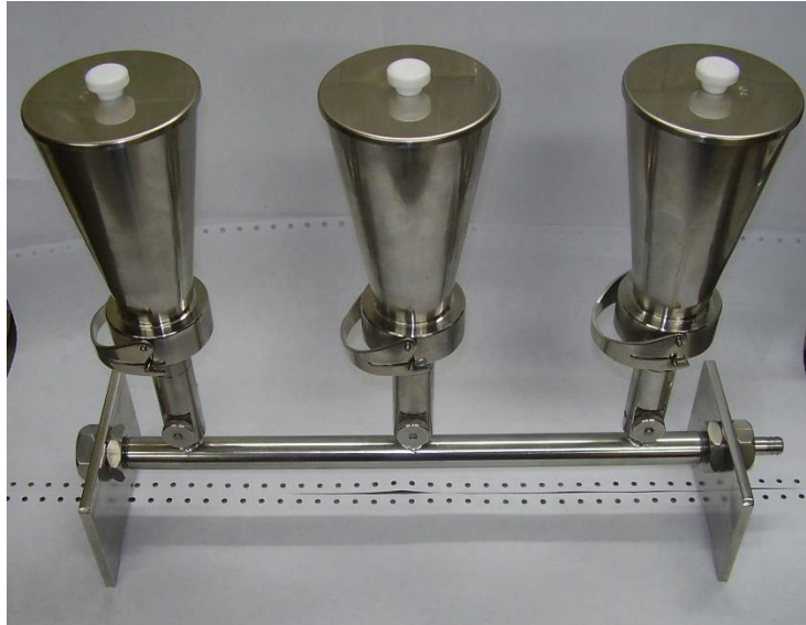
Slika 7. Uređaj za membransku filtraciju (Oprema za filtriranje, url)
