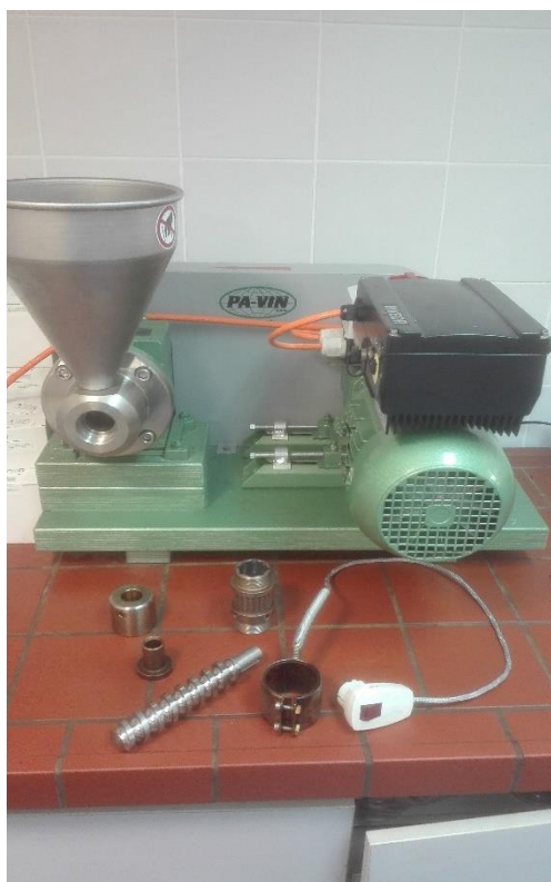
Slika 10. Preša KOMET – rastavljena (Izvor-autor)
