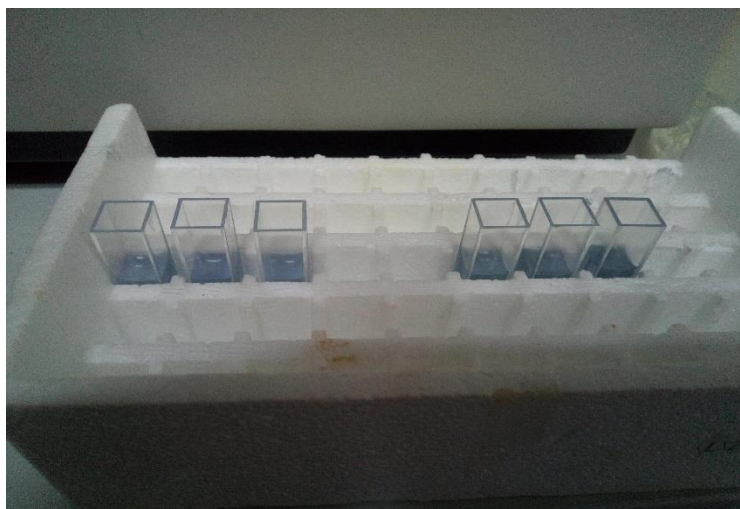
Slika 14. Obojeni produkt čaja i Folin-Ciocalteuova reagensa prije mjerenja u spektrofotometru (Izvor: Autor)
