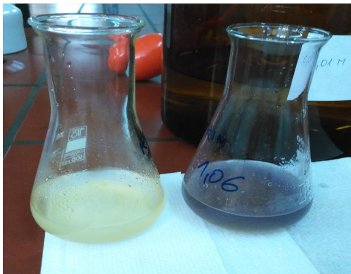
Slika 5. Titracija s otopinom natijeva tiosulfata kod određivanja peroksidnog broja ulja (Izvor: autor)
