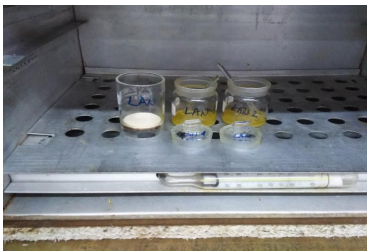
Slika 6. Određivanje udjela vode u ulju (Izvor: autor)
