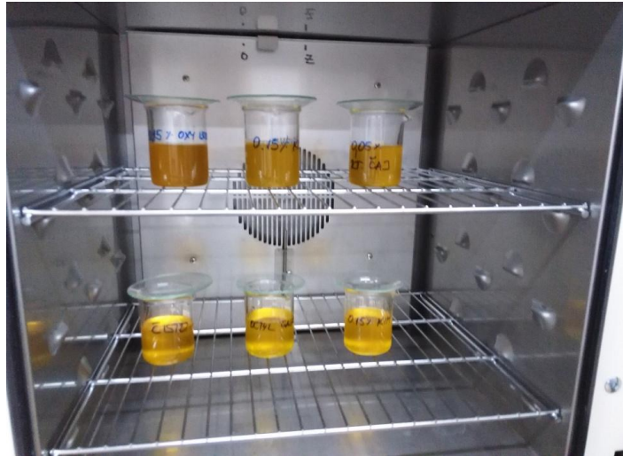
Slika 7. Termostat za određivanje oksidacijske stabilnosti lanenog ulja (Izvor: autor)
