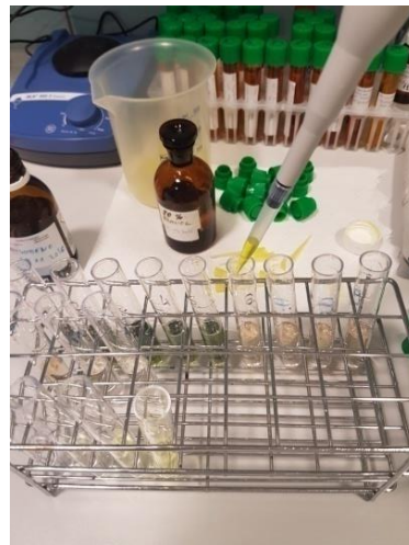
Slika 14. Dodavanja Folin-Ciocalteuovog reagensa (Izvor: autor)
