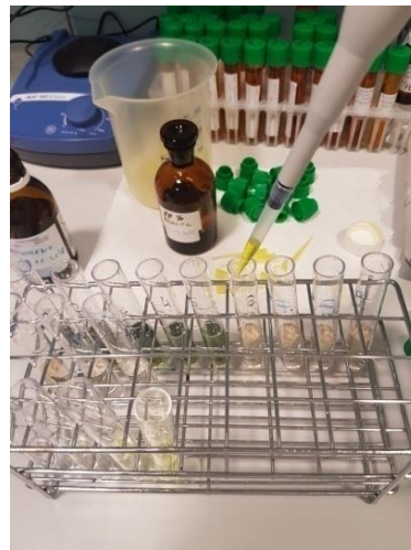
Slika 14. Dodavanja Folin-Ciocalteuovog reagensa (Izvor: autor)
