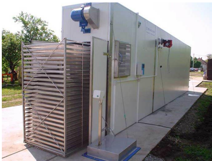
Slika 8. Tunelska sušnica za voće (Izvor: Anonymus_8, 20.06.2017., url)
