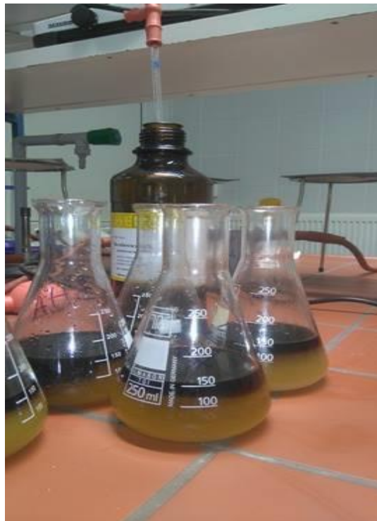
Slika 6. Uzorak s otopinom škroba (Izvor: autor)
