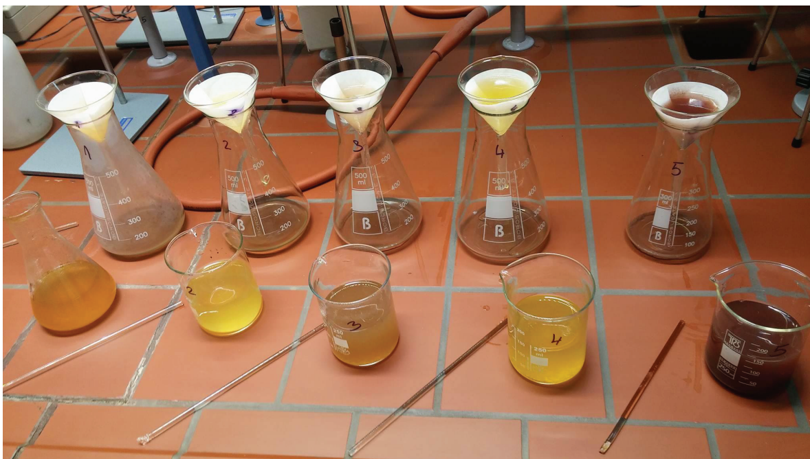
Slika 7. Filtriranje otopina preko filter papira (Izvor: autor)
