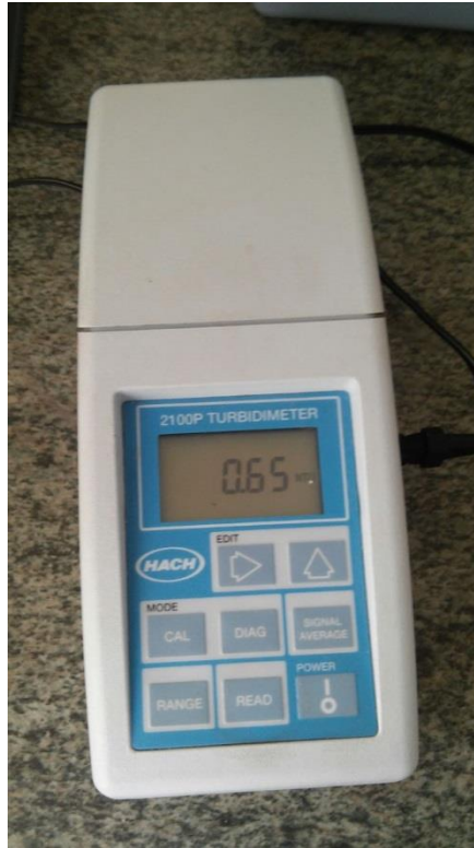
Slika 1. Turbidometar (Izvor: autor)
