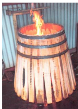
Slika 12. Paljenje bačve (Izvor: AUREAmarketing, TOFRADO Barrique, 09.04.2017.)
