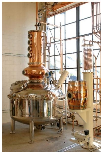
Slika 4. Uređaj za "batch" destilaciju
