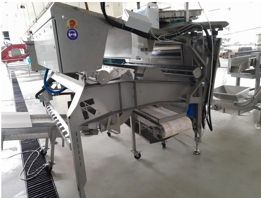
Slika 5. Optički sorter i 1. inspeksijska traka (Izvor: Autor)
