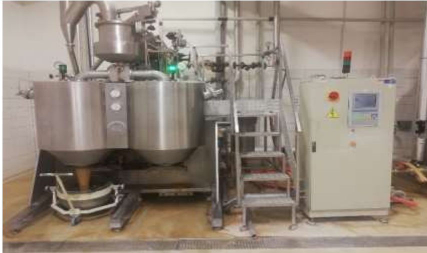
Slika 5. Vakuu ugušćivač (izvor: autor)
