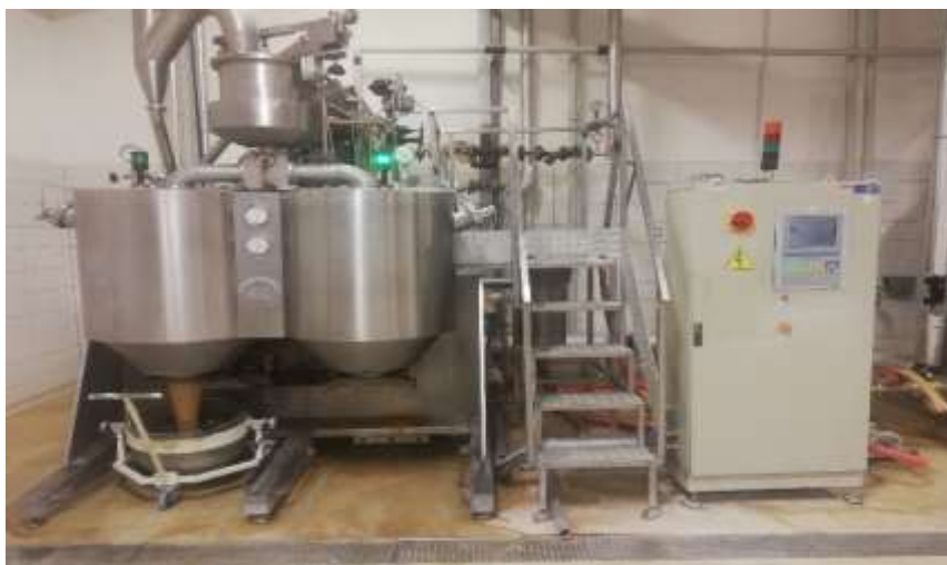
Slika 5. Vakuuum ugušćivač (izvor: autor)
