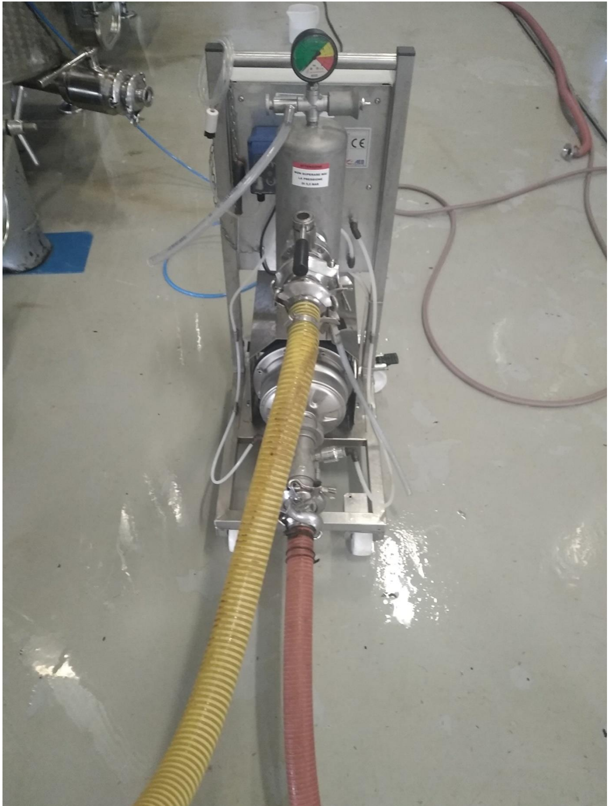
Slika 2. Flotator E - Flot 5 (Izvor: autor)
