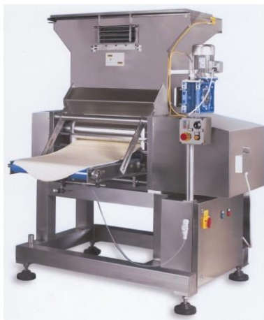
Slika 5. Uređaj za ekstruziju i laminarenje (Pastaria HUB, n. d., URL)
