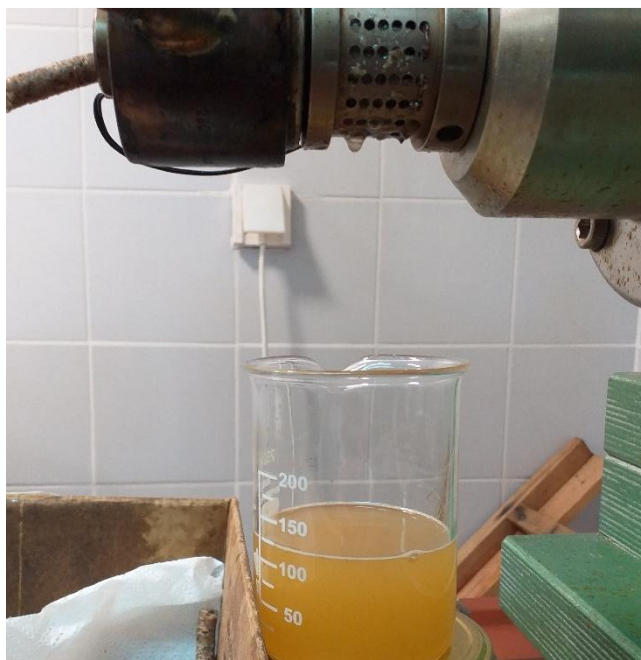
Slika 14. Postupak odvajanja ulja prilikom hladnog prešanja (Izvor: autor, 2020.)
