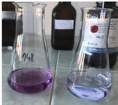
Slika 7. Određivanje ukupne tvrdoće vode (Izvor: autor)
