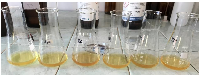
Slika 5. Određivanje klorida u vodi (Izvor: autor)
