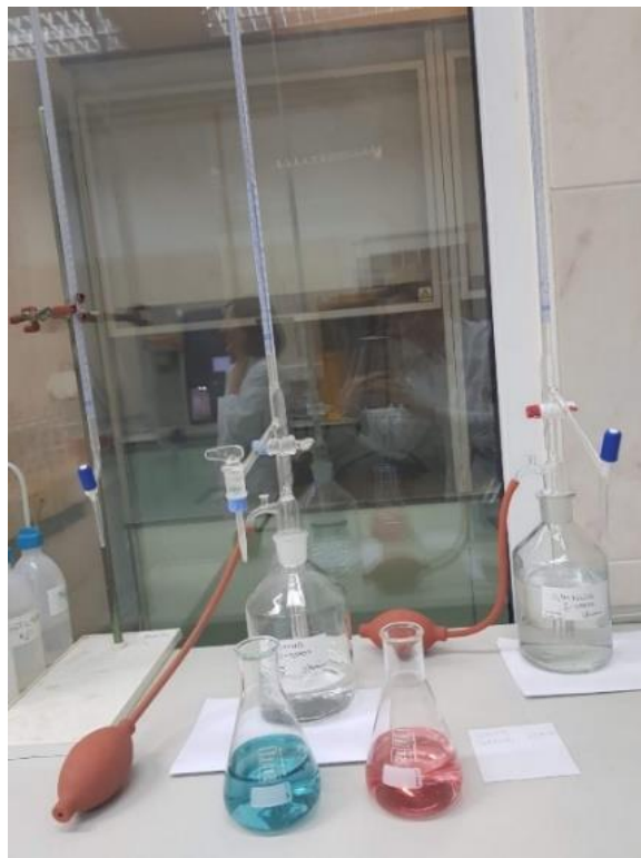
Slika 7. Postupak titracije (Izvor: autor)
