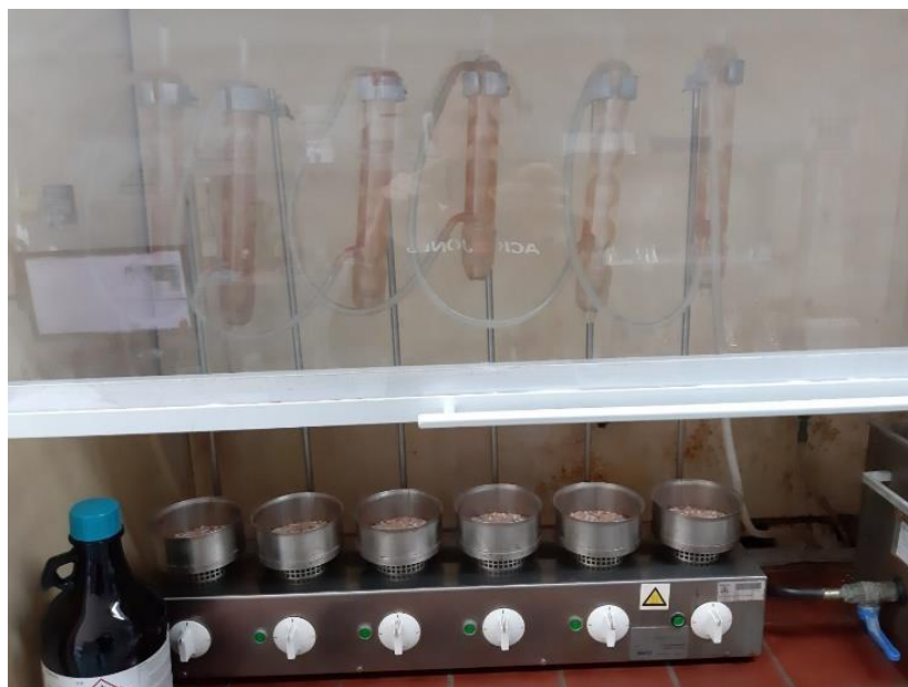
Slika 5. Ekstrakcija u Soxhlethovom uređaju (Izvor: autor)
