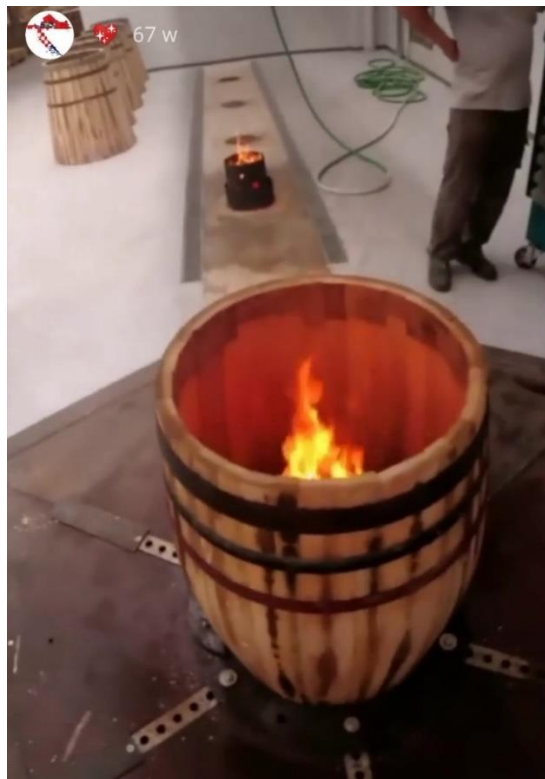
Slika 8: Proizvodnja hrastovih bačava u Auric Barrels u Našicama - vlastiti izvor
