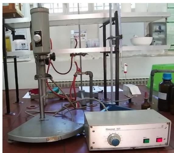
Slika 5. Rotacijski viskozimetar tip "Rheomat 15T" (Izvor: autor)
