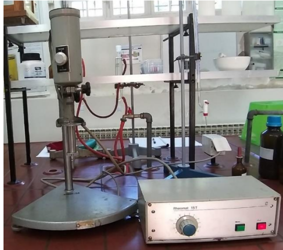
Slika 5. Rotacijski viskozimetar tip "Rheomat 15T" (Izvor: autor)
