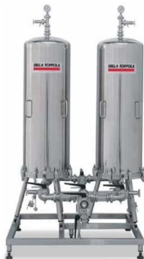
Slika 34. Membranski pročistač (izvor: www.dellatoffola.it )
