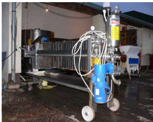
Slika 36. Filtar tijesak sa klipnom pumpom (vlastiti izvor)
