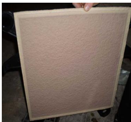
Slika 33. Filter ploča nakon filtracije (vlastiti izvor)
