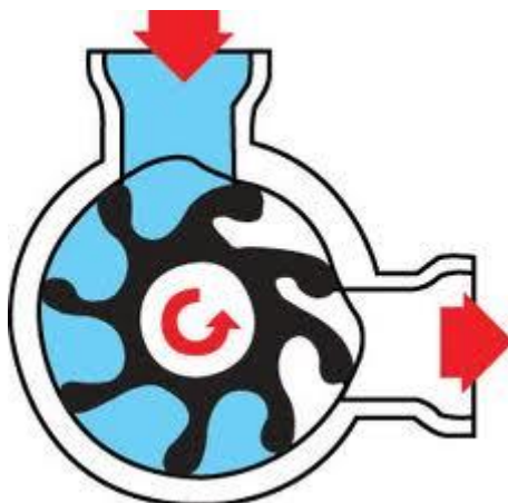
Slika 24. Princip rada impelerske crpke (izvor:www.eriks.co.uk)
