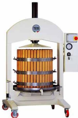
Slika 18. Vertikalni hidraulični tijesak (izvor: www.renaioli.net )
