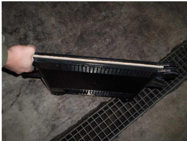
Slika 32. Okvir s pločom pločastog filtra (vlastiti izvor)
