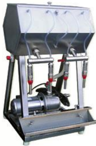
Slika 42. Primjer poluautomatskih punionica za vino (izvor: www.kokot-agro.hr )
