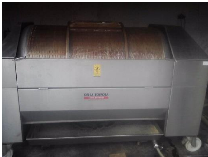
Slika 19. Pneumatski tijesak - otvoreni tip (vlastiti izvor)
