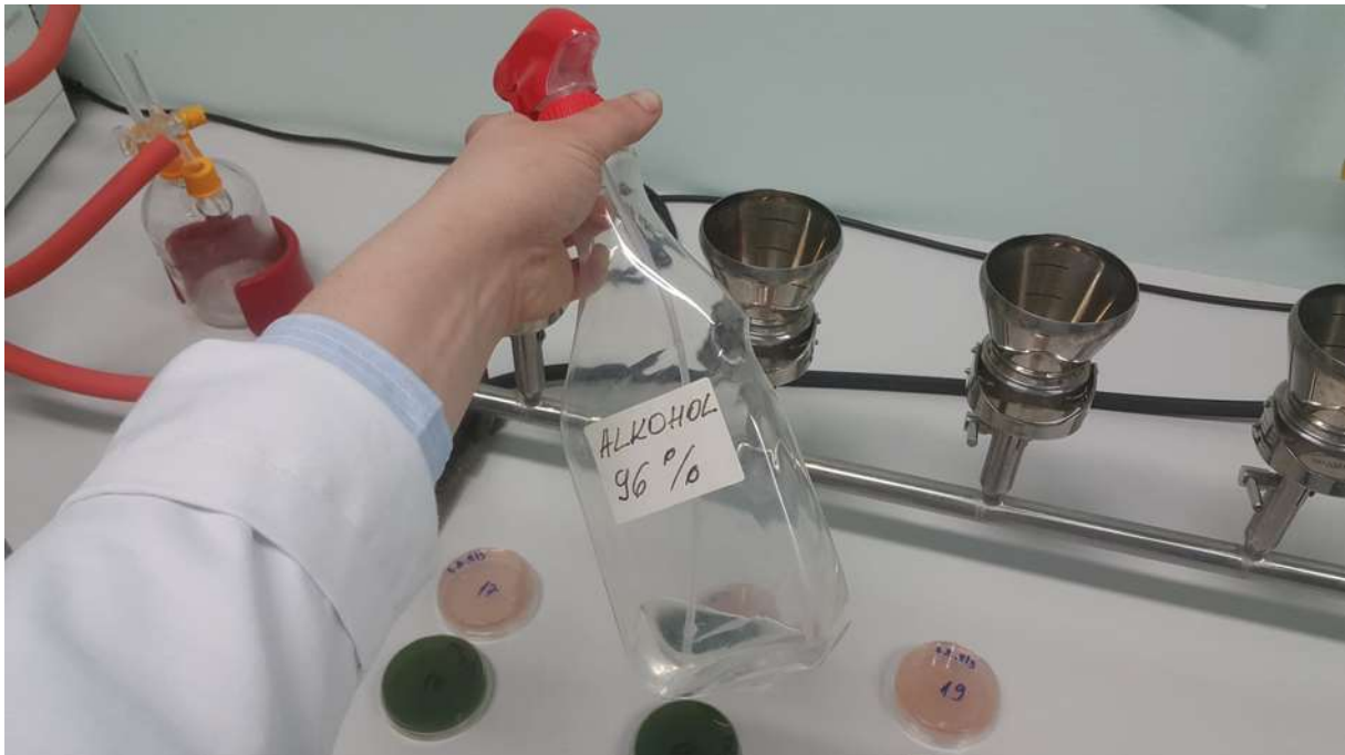
Slika 4. Sterilizacija pomoću 96 % alkohola (Izvor: autor)
