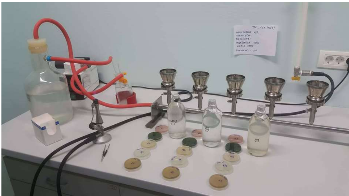
Slika 3. Uređaj za membransku filtraciju (Izvor: autor)
