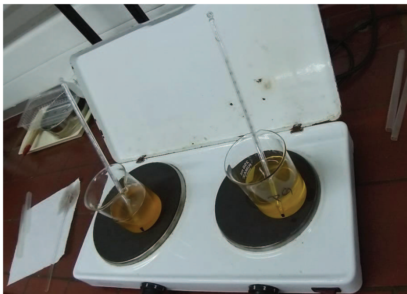
Slika 11. Zagrijavanje ulja uz dodatak antioksidansa, (Izvor: Autor)
