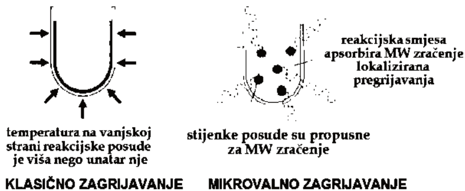
Slika 7. Shematski prikaz klasičnog i mikrovalnog zagrijavanja, ( FKIT, URL)
