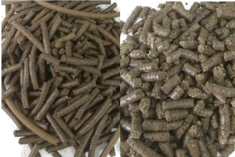
Slika 10. Usporedba pogača dobivenih pomoću nastavaka veličine 7 mm i 9 mm (izvor: autor)
