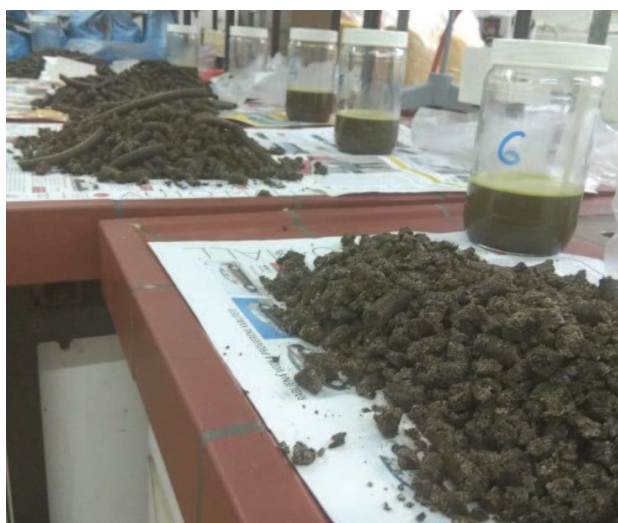
Slika 5. Proizvedeno sirovo ulje konoplje i nusprodukt pogača (izvor: autor)
