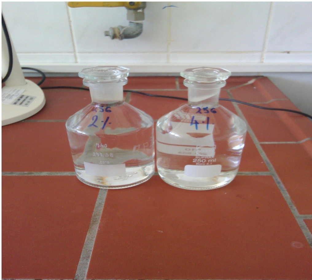
Slika 6. Winkler boce za određivanje BPK 5
