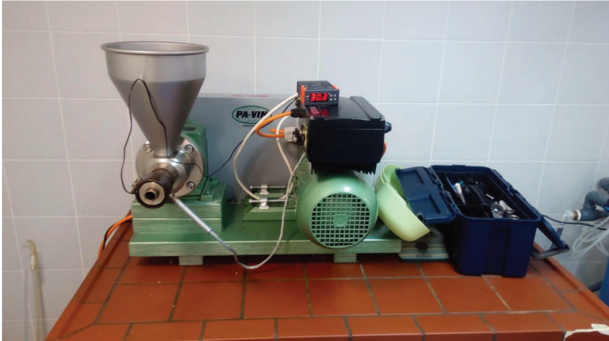
Slika 14. Vijčana preša KOMET CA 59 G, izvor: autor, 2019.
