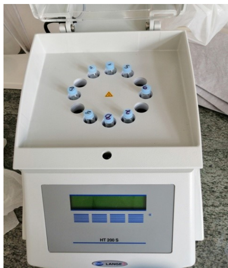
Slika 5. Termoreaktor sa kivetama prije zagrijavanja (autor)
