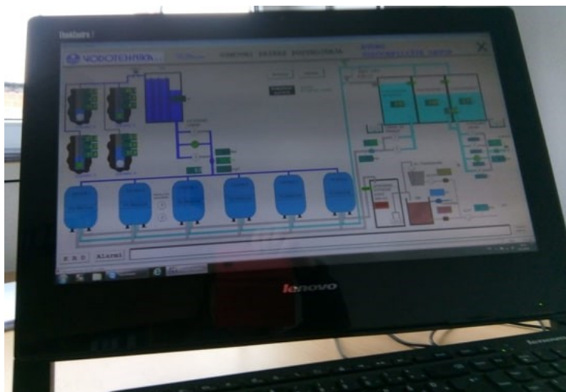
Slika 8. Računalni sustav za nadzor i upravljanje SCADA (Izvor: autor)
