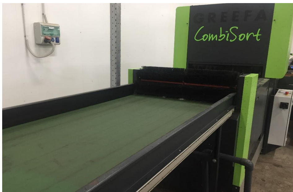
Slika 6. Nastavak uređaja za sortiranje koji vodi do stolova za klasiranje (Izvor: Autor)
