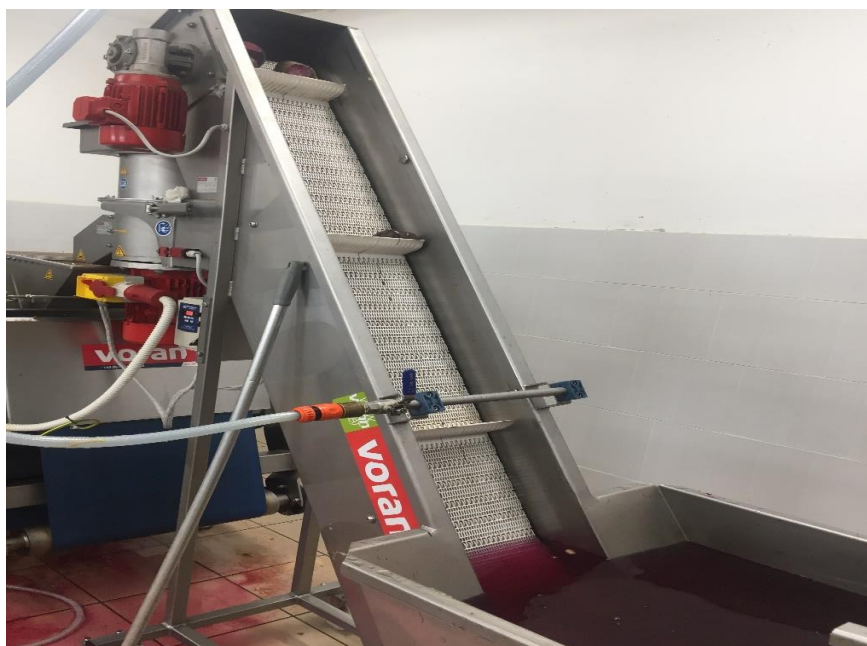
Slika 9. Kada za pranje voća i elevator (Izvor: Autor)
