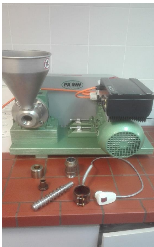
Slika 10. Preša KOMET – rastavljena (Izvor-autor)
