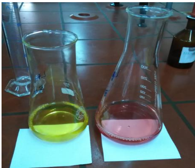
Slika 4. Određivanje SMK titracijom s NaOH (Izvor: autor)
