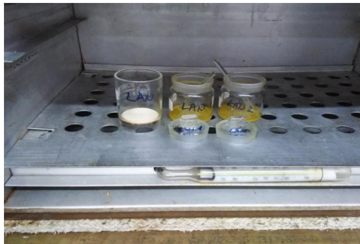
Slika 6. Određivanje udjela vode u ulju (Izvor: autor)
