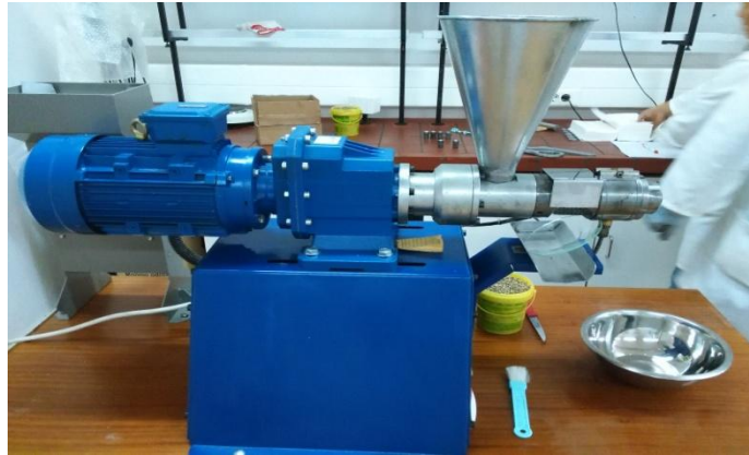
Slika 2. Kontinuirana pužna preša (Izvor: autor)
