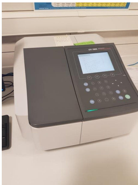
Slika 16. Uređaj za UV-VIS spektroskopiju, UV-1800 Schimatzu spektrofotometar (Izvor: autor)
