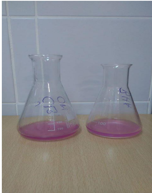
Slika 7. Određivanje kiselinskog broja (Izvor: autor)
