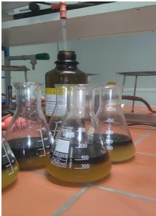
Slika 6. Uzorak s otopinom škroba (Izvor: autor)
