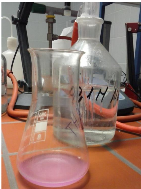
Slika 8. Određivanje kiselnog broja (Izvor: autor)
