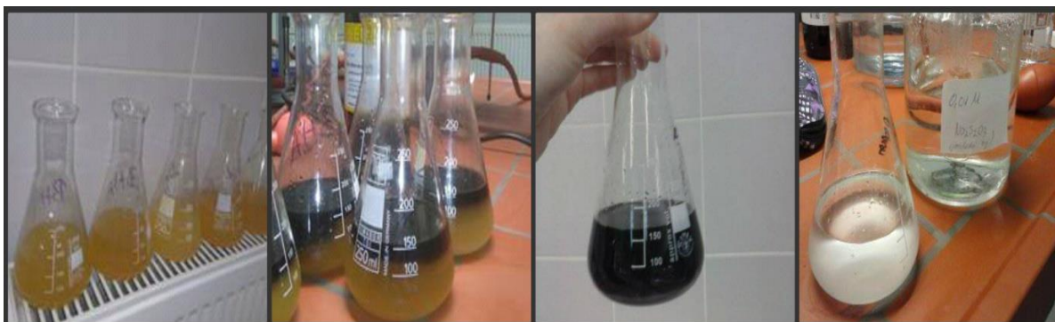
Slika 9. Određivanje peroksidnog broja (Izvor: autor)
