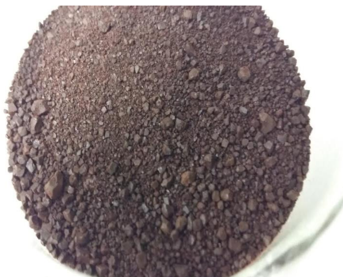
Slika 9. Filtarski materijal – Hydrofilt (Izvor: autor)
