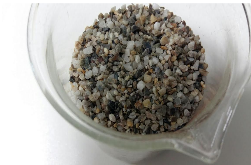
Slika 8. Kvarcni pijesak 0,71-1,25 mm (Izvor: autor)
