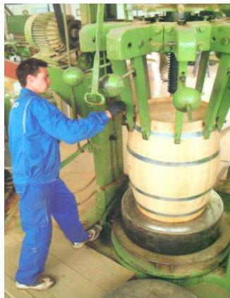
Slika 16. Strojno navlačenje željeznih obruča (Izvor: AUREAmarketing, TOFRADO Barrique, 09.04.2017.)
