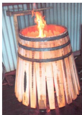
Slika 12. Paljenje bačve (Izvor: AUREAmarketing, TOFRADO Barrique, 09.04.2017.)
