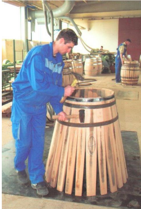
Slika 11. Slaganje plašta bačve (Izvor: AUREAmarketing, TOFRADO Barrique, 09.04.2017.)
