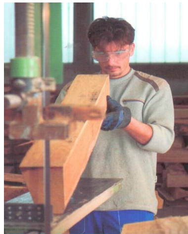
Slika 6. Strojno piljenje i izrada dužice (Izvor: AUREAmarketing, TOFRADO Barrique, 07.04.2017.)
