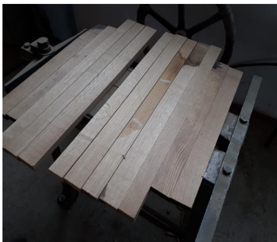
Slika 14. Priprema za proizvodnju glave bačve (Vlastiti izvor)
