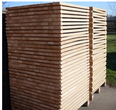
Slika 7. Sirova dužica spremna za sušenje (Izvor: Anonymus_3, 09.04.2017, url)
