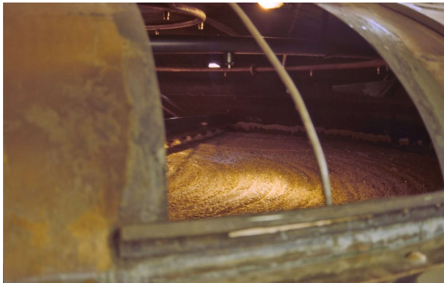
Slika 3. Proces gnječenja ječmenog slada (Whisky, url)
