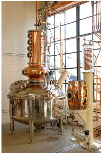
Slika 4. Uređaj za "batch" destilaciju
