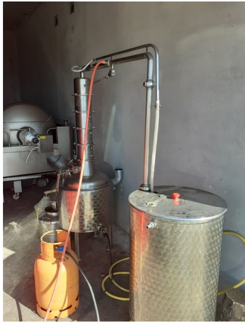
Slika 7. Proces destilacije ječmenog slada (Izvor: autor)
