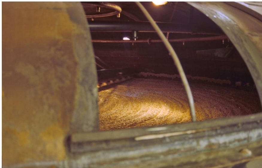
Slika 3. Proces gnječenja ječmenog slada (Whisky, url)
