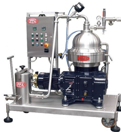
Slika 7. Uređaj za centrifugiranje vina (The Vintner Vault_2, n.d., URL)
