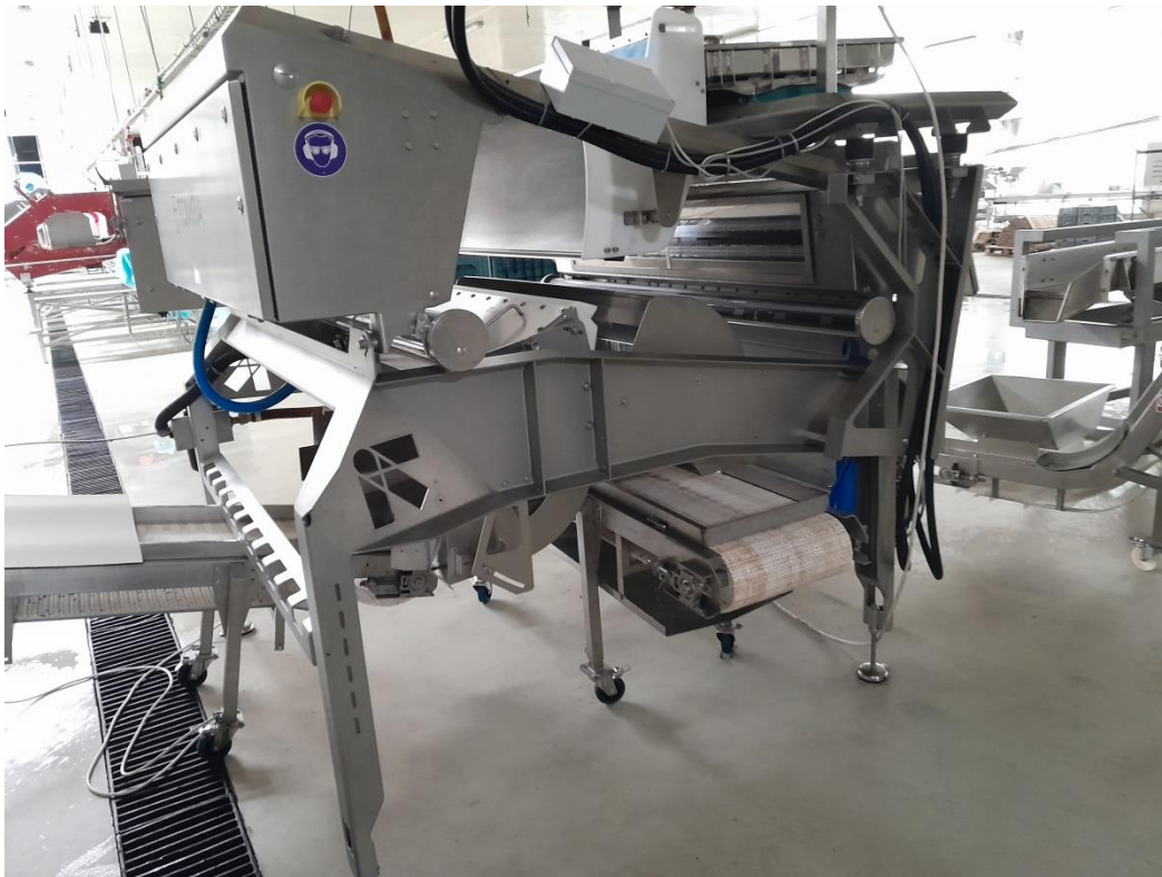
Slika 5. Optički sorter i 1. inspeksijska traka (Izvor: Autor)
