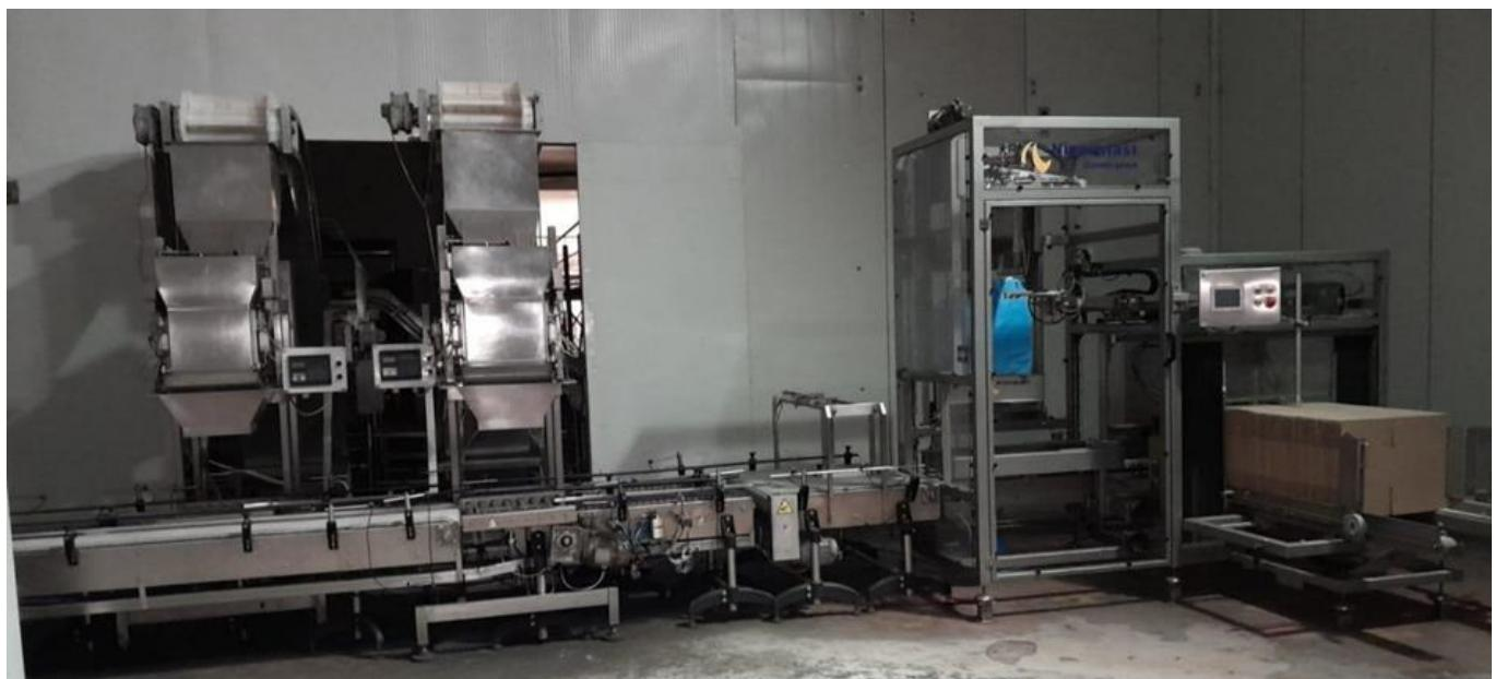
Slika 9. Automatske vage i stroj za pravljenje kutija
