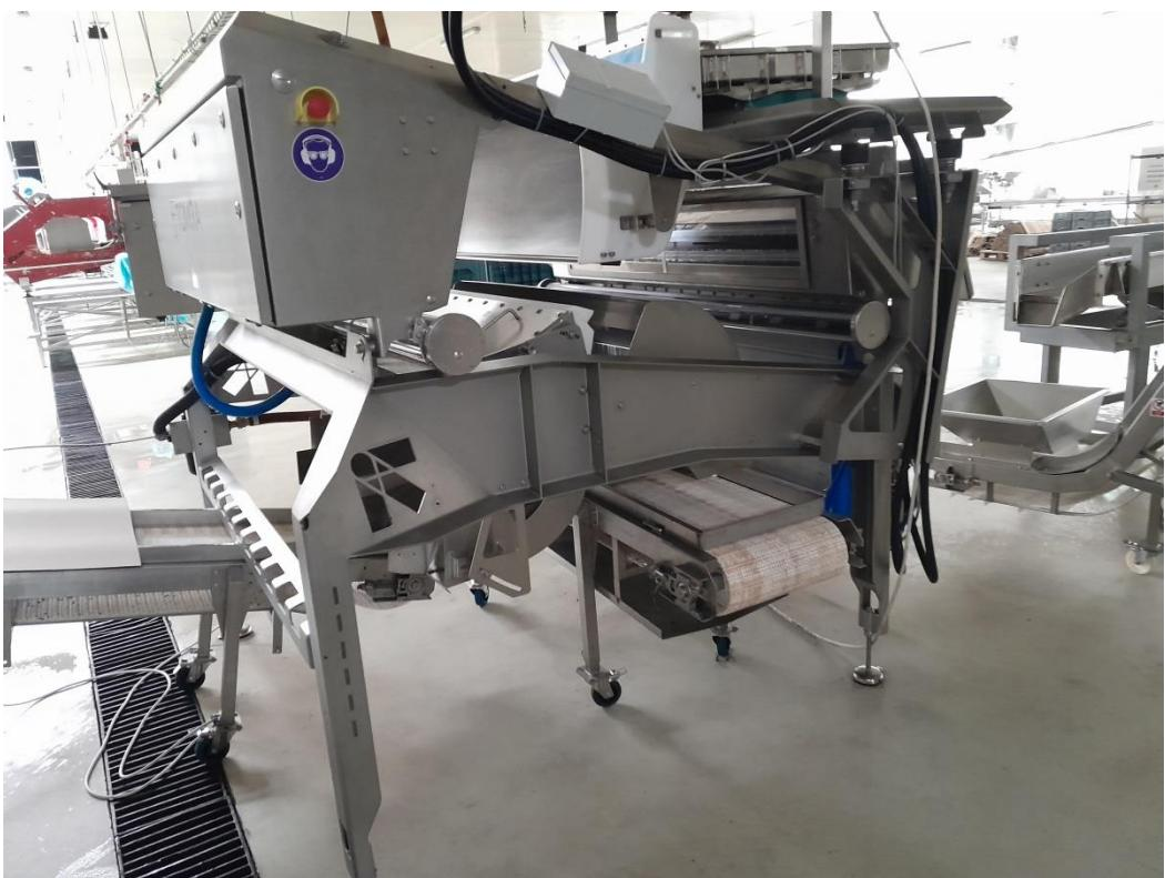
Slika 5. Optički sorter i 1. inspekcijska traka
