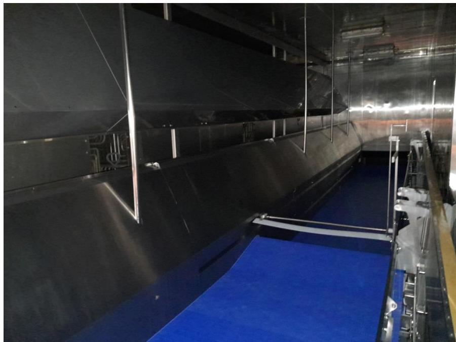
Slika 7. Protočni tunel za smrzavanje
