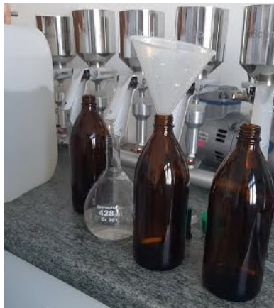
Slika 5. Ulijevanje uzoraka otpadne vode u boce za određivanje BPK 5 (Izvor: autor)
