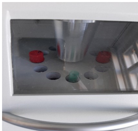
Slika 3. Zagrijavanje uzoraka u termoreaktoru (Izvor: autor)
