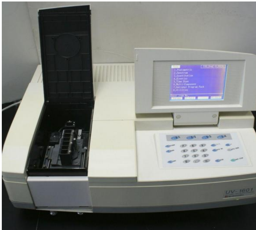
Slika 5. Uređaj SHIMADZU 1601- spektrofotometar(Bimedis, url)
