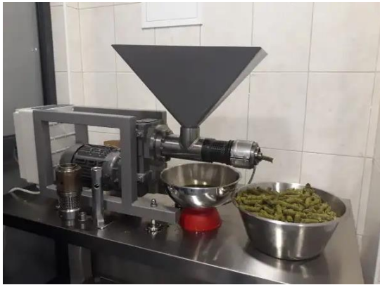
Slika 8. Pužna preša (Oblizeki. 18.6.2022., URL) Slika 9. Pogača (Oblizeki. 18.6.2022., URL)
