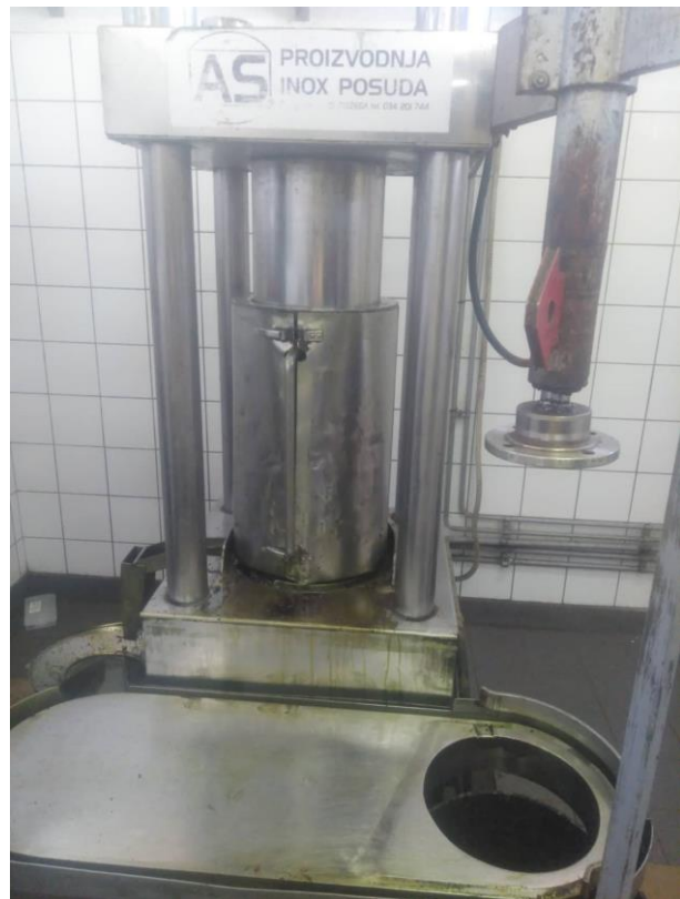
Slika 11. Hidraulična preša (Izvor: autor)
