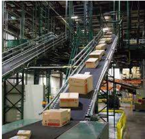
Slika 28. Trake za prijenos robe do kamiona
