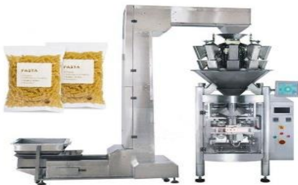
Slika 6. Stroj za pakiranje tjestenine (Eastern Pack, n. d., URL)
