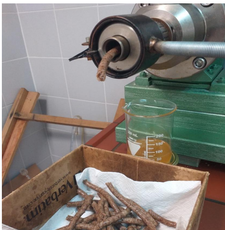
Slika 15. Pogača koja se odvaja u trenutku prešanja (Izvor: autor, 2020.)
